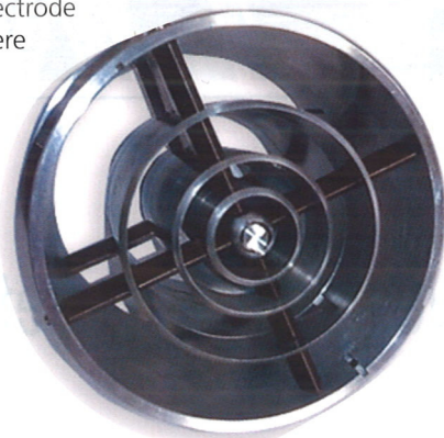
▷ Capteur multi-électrodes (diamètre de la canalisation : 120 mm).
